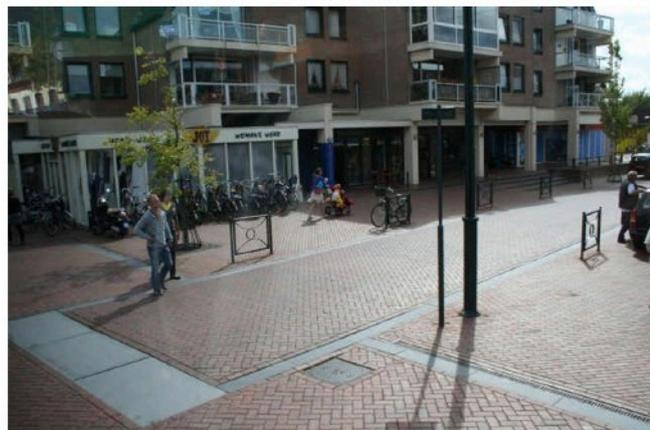
Shared Space Beispiel aus Haren, NL, mit Gittern zur Trennung der Fahrbahn vom Rad-/Gehwegbereich
